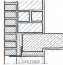
(تصویر 10.1.6: نمونه دیوار که بیرون نمای آنرا خشت های بدون پلاستر تشکیل داده و گادر فلزی L بالای دهانه بعنوان سرطاق می باشد)
