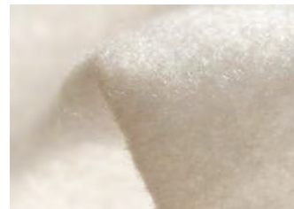
(تصویر 15.5.8: تکه و یا فویل Geotextilia Filtek)
