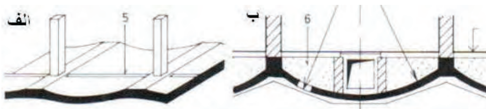
(تصویر 6.2.17: تهاب کانکریتی مسطح جعبه ای یا قطعه ای)
