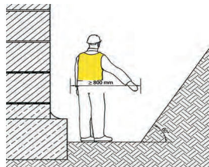
(تصویر 5.3.3: کندنکاری ته‌داب ها تحت زوایای مختلف)
