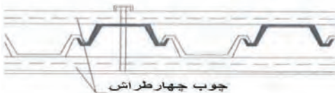
(تصویر 5.3.10: دیوار بندی دندانان دار فلزی)
