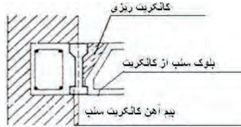
(تصویر 11.7.2: مقطع سلب پیش ساخته شده آهن کانکریت فابریکه ای)
