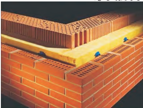
(تصویر 9.7.1: دیوار احاطوی مرکب از خشت پخته بلوک ای بردارنده، ترموایزولشن و خشت پخته ساده میان خالی)
