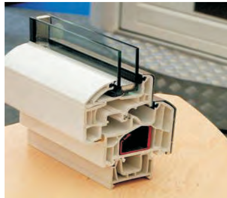
(تصویر 16.5: نمونه از کلکین با شیشه عایق دار دو جداره - این کلکین ها به صورت عموم داری ضریب عبور حرارتی U=1.3 - 1.8 \text{ W/m}^2 \cdot K می باشند)
