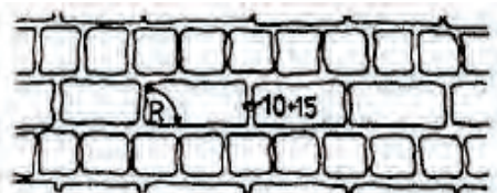
(تصویر 9.2.5: نمونه دیوار سنگی تراش شده اطراف آن الی 5 سانتی متر به عمق سنگ با چین سنگ ها بشکل خط های مستقیم)
