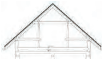
(تصویر 15.1.5: نمونه بام مایل گادری که توسط سیستم ستونهای ایستاده راست اعمار گردیده است)
