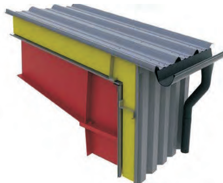
(تصویر 15.3.2: نمونه بام مایل چوکاتی فلزی سیستم BORGHA HALE)
