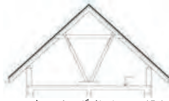
(تصویر 15.1.6: نمونه بام مایل گادری که توسط سیستم ستون های خمیده یا مایل اعمار گردیده است)
