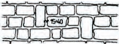
(تصویر 9.2.6: نمونه دیوار سنگی با چین سنگ ها بشکل صلیب با فاصله های ضخیم از همدیگر)
