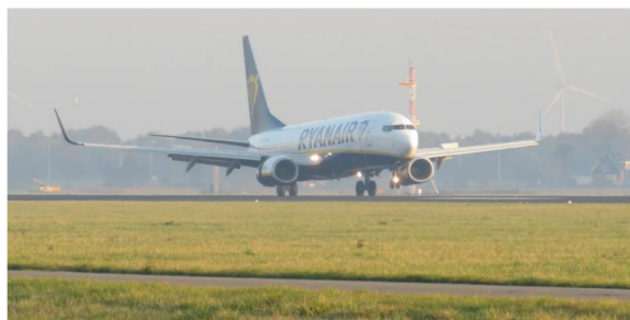
انځور 10.19 د الوتکې د شا یا عمده (Main Landing Gear) ټایرونه پر ځمکه لگیدلی او وروسته له هغه د پوزی ویل په ځمکه لگیری. (ویب پاڼه)
