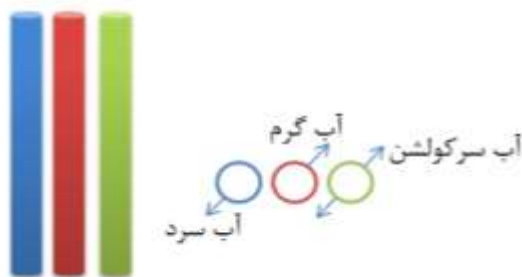
تصویر 2.8. نل های توزیع عمودی - طرز جابجایی نظر به سیستم (SANITAS)
