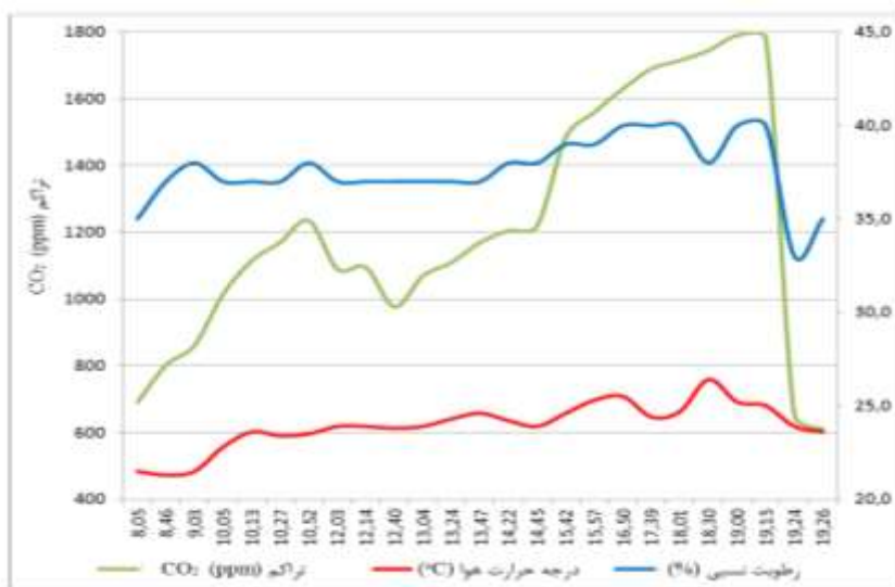
تصویر 3.3 جریان اندازه گیری غلظت CO 2 ، رطوبت نسبی و درجه حرارت هوا در داخل یک اتاق
