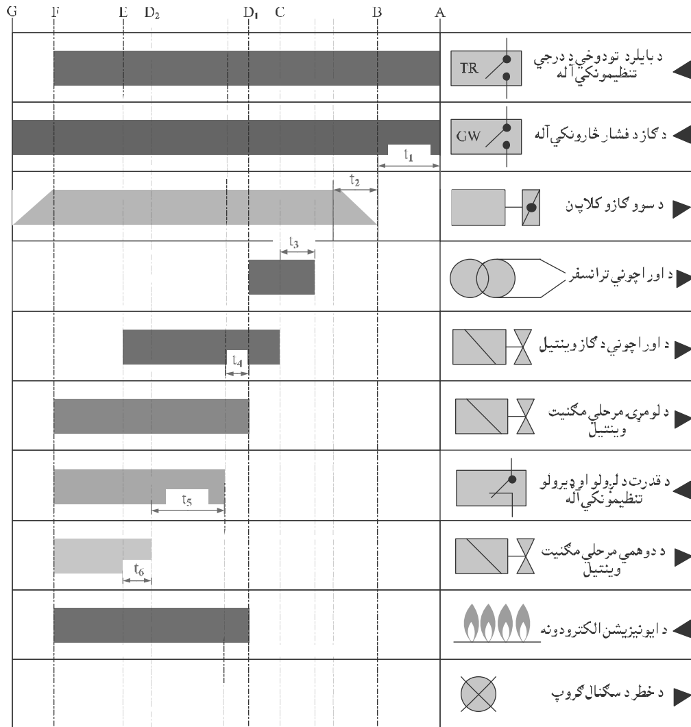
شکل 63- د سون د اتومات د کار پروگرام
