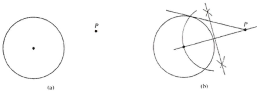
شکل ۱۵: رسم مماس از یک نقطه خارج یک دایره بر آن
