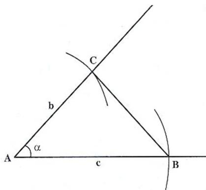
شکل ۸۱: نمایش ترسیم مثلث با معلوم بودن دو ضلع و زاویه بین آن دو ضلع
