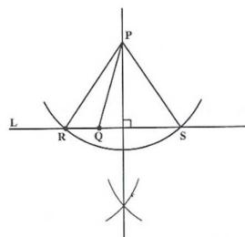
شکل ۶۵: خط عمود بر یک خط از نقطه واقع درخارج آن خط
