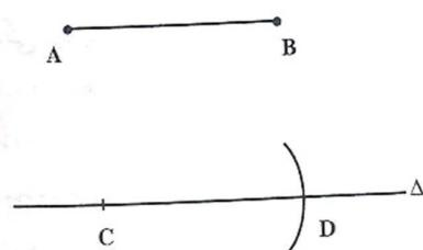
شکل ۶۱: ترسیم یک قطعه خط به آندازه داده شده
