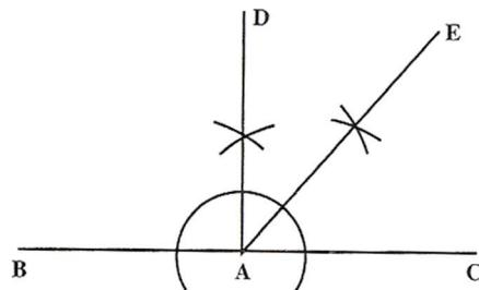
شکل ۴۸۰: ترسیم زاویه  $135^\circ$
