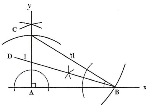
شکل ۴۸۱: ترسیم زاویه  $15^\circ$
