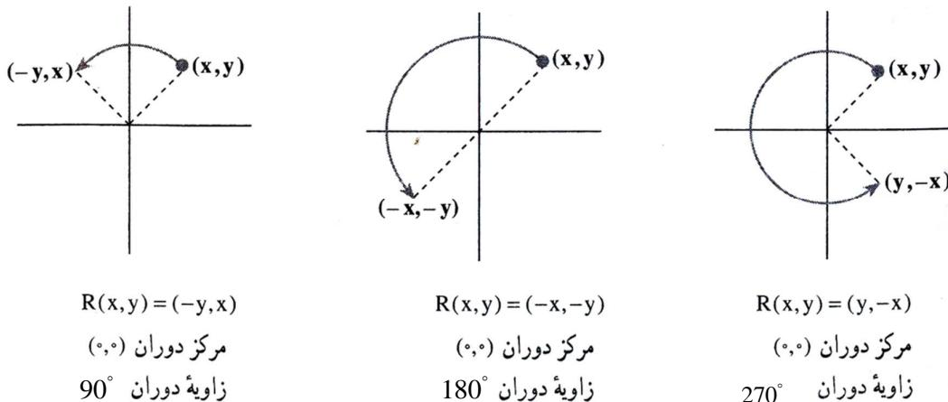
شکل ۲۱۶: مرکز و زاویه دوران  $90^\circ$ ,  $180^\circ$  و  $270^\circ$
