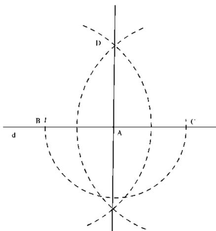
شکل ۷۱: نمایش خط بریک خط مفروض از نقطه‌ای روی آن
