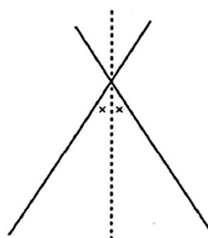
شکل 316: ناصف الزاویه تشکیل شده بین خط و تصویرش محور تناظر است
