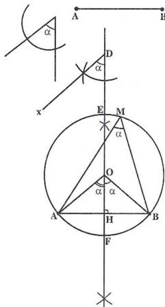
شکل ۱۷۵ : قوس مناسب یک زاویه روبروی یک خط داده شده
