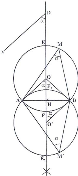
شکل ۱۷۶: قوس مناسب یک زاویه روبروی یک خط داده شده
