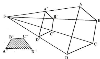
شکل ۲۸۷ : تجانس یک چهارضلعی (ارتسام مرکزی نظریه نقطه  $S$ )
