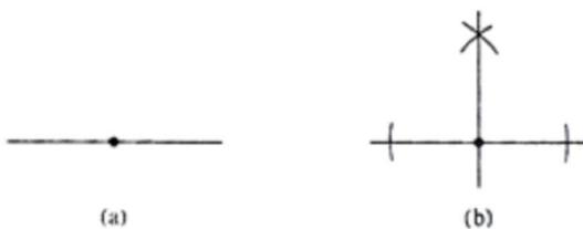
شکل 9: رسم عمود بر یک خط از نقطه معینی واقع بر آن
