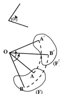
شکل ۲۱۷: دوران یافته یک شکل نسبت به مرکز ( $O$ )
