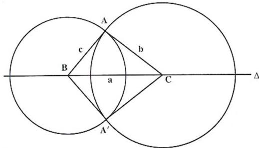
شکل ۸۲: نمایش ترسیم مثلث با معلوم بودن سه ضلع توسط قطع دو دایره از نقطه A به B و C وصل می کنیم مثلث رسم می شود. شرط امکان مسئله آن است که  $|b - c| < a < b + c$ .
