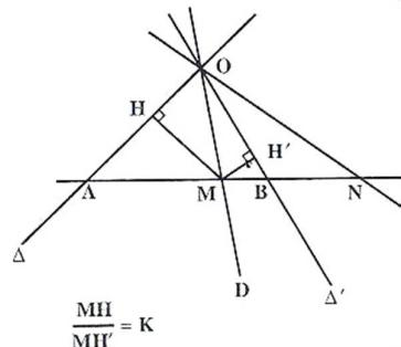
شکل ۴۲(الف) : خطوط توافقی و راس سیستم توافقی خطوط
