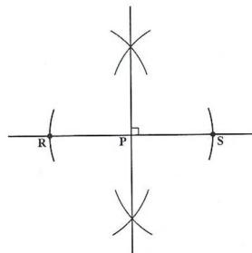
شکل ۶۴: نمایش ترسیم خط عمودی بر یک خط از یک نقطه واقع بر آن خط
