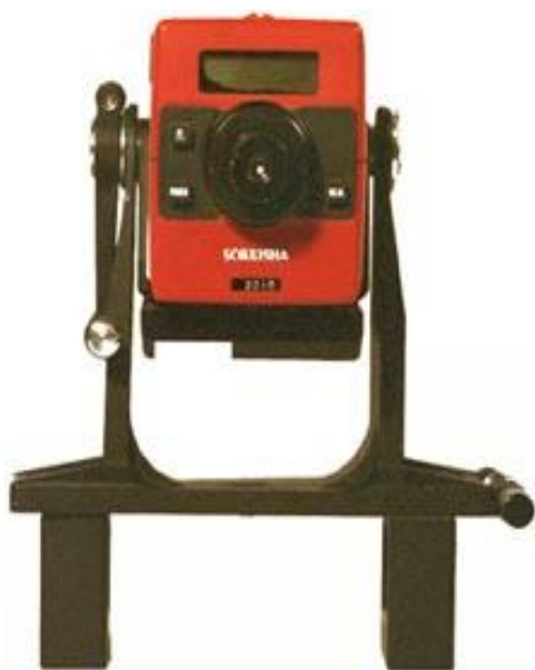
2.16 شکل: اليکټرونيکي فاصله اندازه کوونکي
