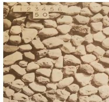
13a.9 شکل: تخریب شوی اګریگیت 13b.9 شکل: د قالبونو په واسطه جوړ شوي شکلونه
