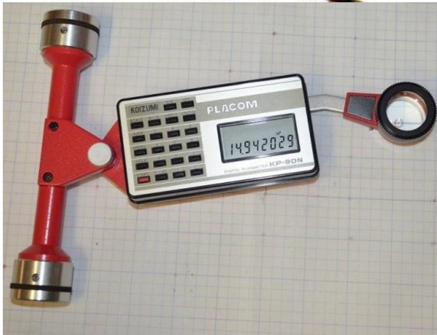
شکل (۱۱۶): پلانیمترهای حساس که در اندازه گیری ها مختلف موثر واقع شده است.
