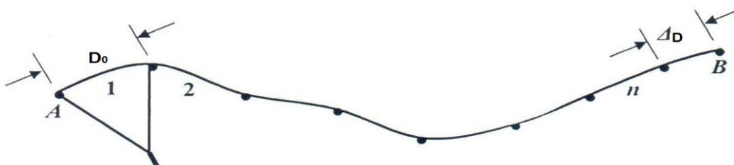
شکل (۱۱۰): اندازه گیری خطوط منحنی (کج) به کمک دو سوزنه که البته مسافه باقیمانده  $\Delta D$  بصورت جداگانه اندازه میگردد.
